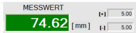
Der aktuelle Messwert [mm] wird in einem separaten numerischen Anzeigefeld dargestellt. Ferner wird die Größe des [+] [-] Toleranzbandes [mm] in zwei weiteren Anzeigen dargestellt.
